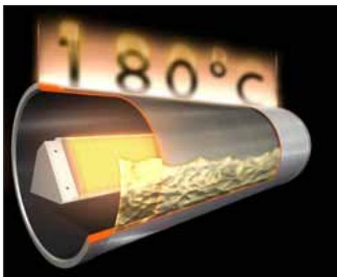
Cylindre multicouche à fluide thermique Dubixium™ garantissant un fonctionnement constant grâce à la disparition des surchauffes des côtés.
