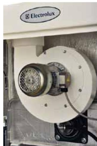
Efficacité de séchage la meilleure du marché grâce à une aspiration des buées de gros diamètre et réglable sur chaque cylindre
